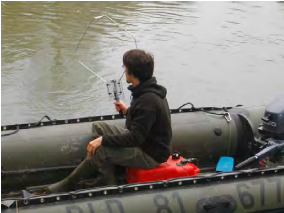
Figure 17 : Prospection embarquée à l'aide d'une antenne boucle
