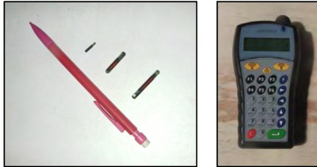
*Figure 19 : Pit-tags de 3 tailles différentes, utilisés pour le marquage des autres migrateurs amphihalins (photo de gauche) et lecteur manuel de pit-tag (photo de droite) (FDPPMA 62)*
