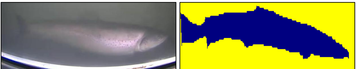
► Figure 4 : Capture d'image d'une séquence vidéo et silhouette fournie par le scanner
