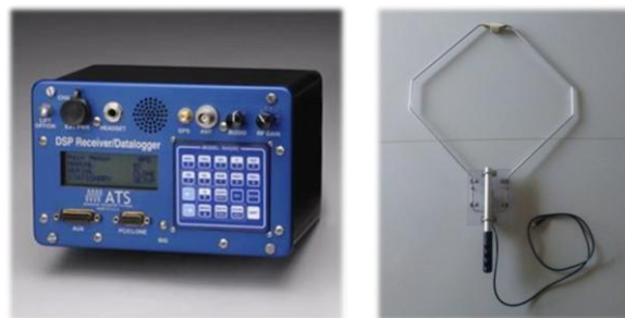
► Figure 17 : Récepteur et antenne utilisés pour le radiopistage des individus (FDPPMA 62)
