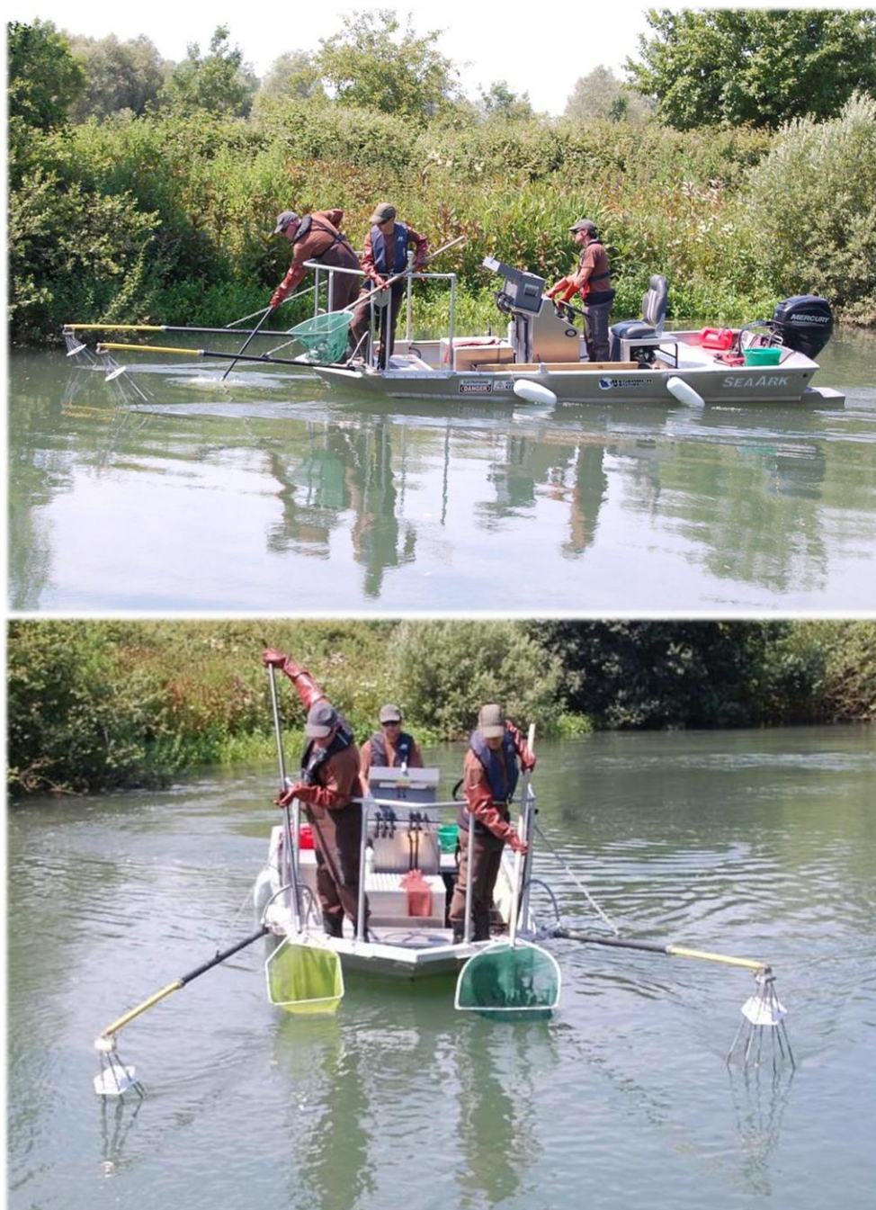
► Figure 13 : Echantillonnage sur le bas de Canche avec l'Electrofishing-boat (FDPPMA 62)
