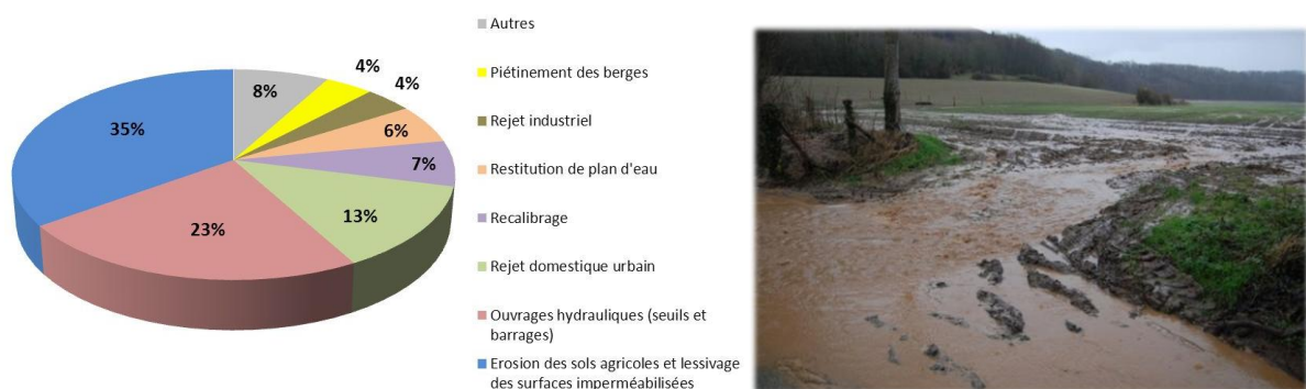
► Figure 2 : Facteurs de perturbations sur la capacité de production en salmonidés sur le bassin de la Canche et exemple d'érosion agricole (FDPPMA 62 et SYMCEA)
