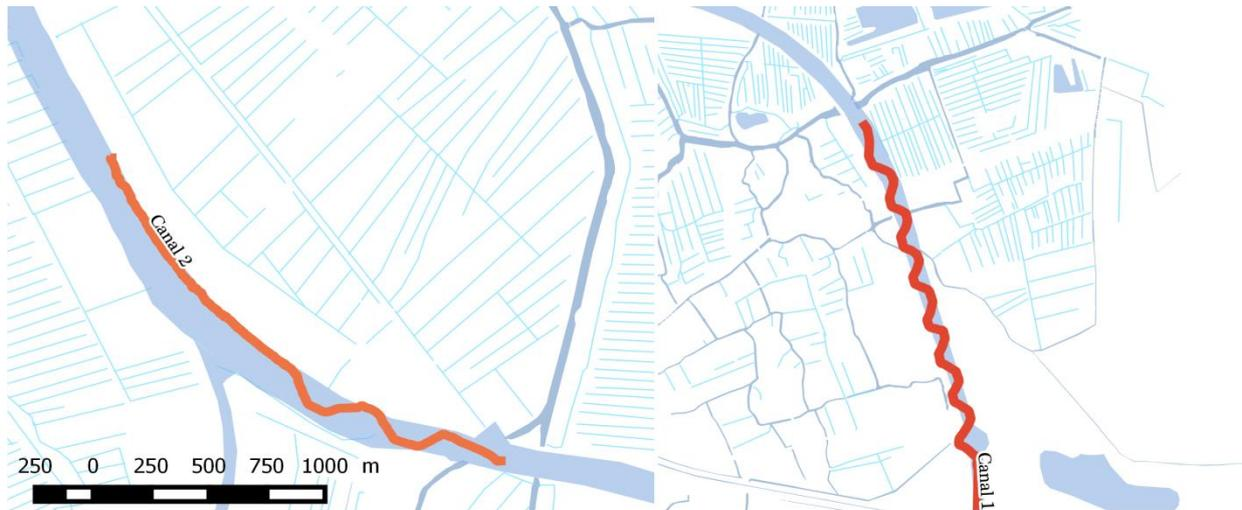
Figure 10 : Localisation et réseau hydraulique adjacent aux stations « Canal2 » et « Canal1 » située à l'aval de l'écluse des Flandres, respectivement de gauche à droite.
