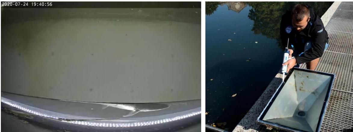
► Figure 9 : *Infiltration dans la chambre de la caméra du Riverwatcher : Résultat de l'image à mi-remplissage à gauche et réparation du joint d'étanchéité à droite*
