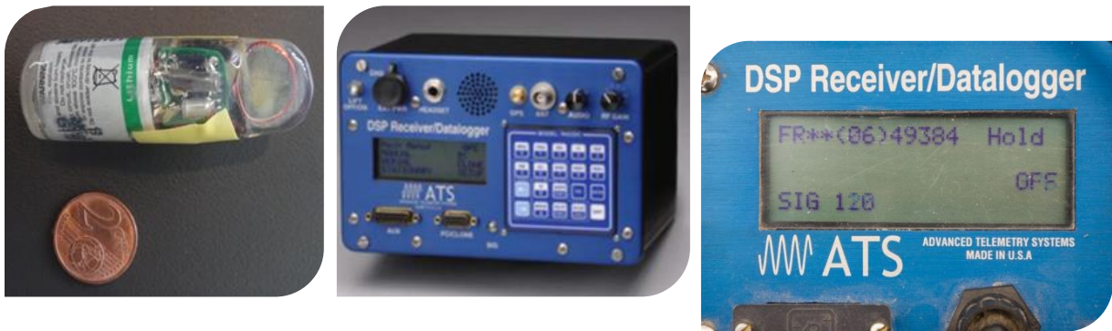
Figure 25 : Émetteur ATS à antenne interne F1230 et postes récepteurs (indicateur de fréquence et d'intensité du signal).
