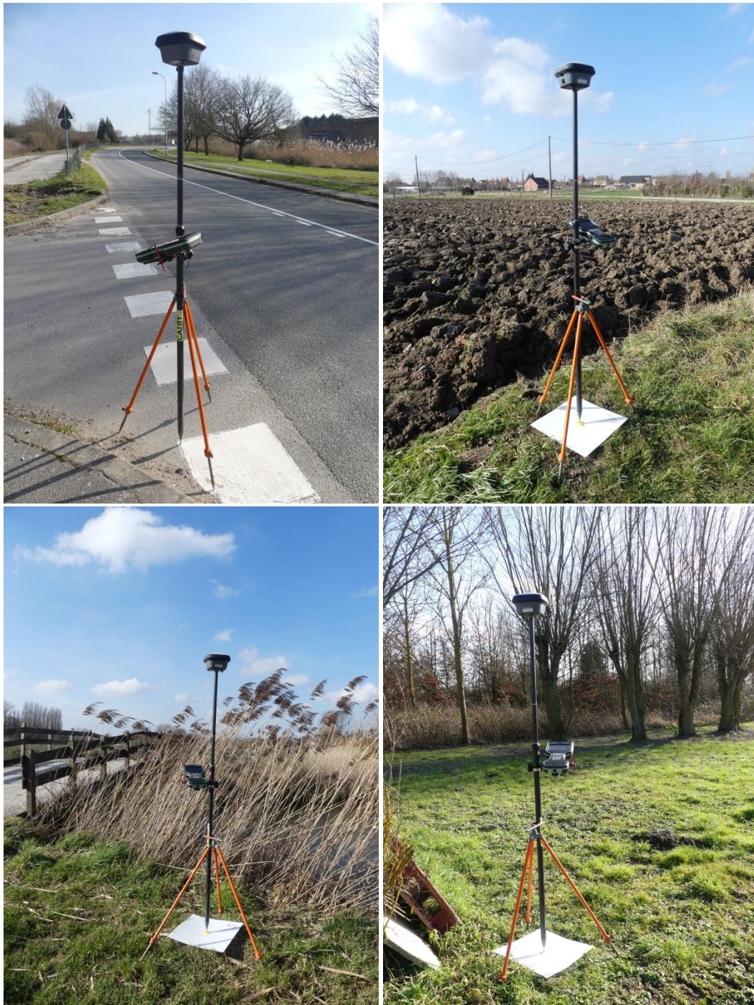
Figure 3 : Etape de « plaquettage ». Poses et géo-référencements des repères au sol afin de relier les dalles photos entrent elles à l'aide d'une station total ou Tachéomètre.
