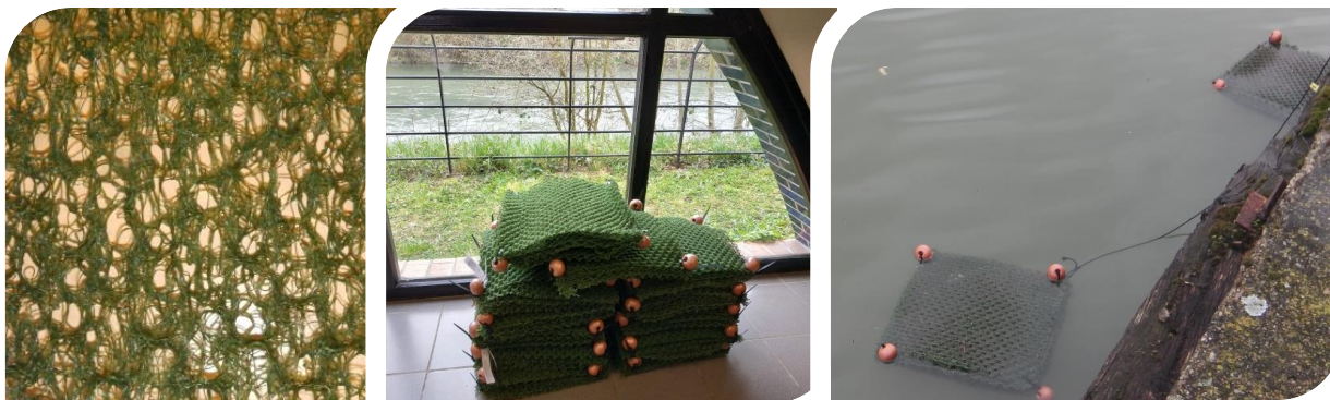
Figure 6 : Gros plan sur la maille du géotextile et flottang vu de dessus.
