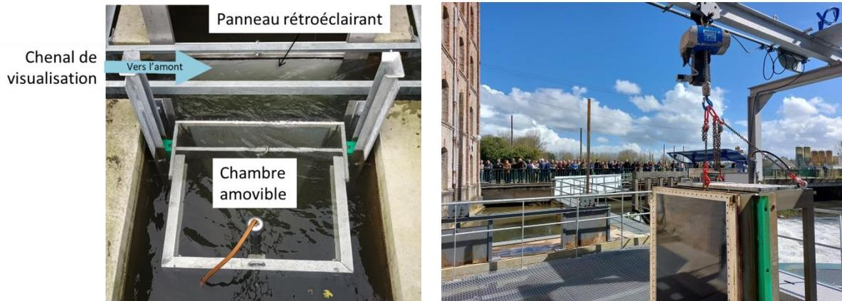
Figure 11 : Chambre amovible et panneau rétroéclairant de l'Ibaï Begi immergé dans le Bassin B0 (à gauche), et chambre amovible en levage le jour de l'inauguration (à droite)
