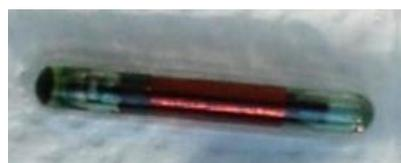
Figure 17 : Photographie d'un émetteur pit-tag
