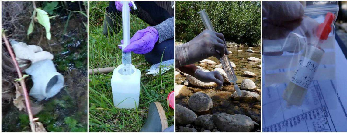
Figure 5. Illustration des étapes de prélèvement, de filtration et de préservation des échantillons d'eau filtrés (capsule Sterivex).
