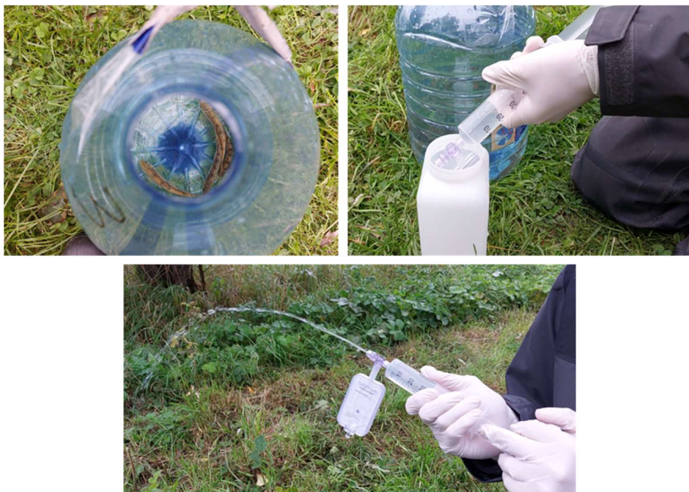
Figure 6. Illustration de la stabulation d'un pool de poissons dans l'eau de source, et filtration de l'eau sur capsule Sylphium.
