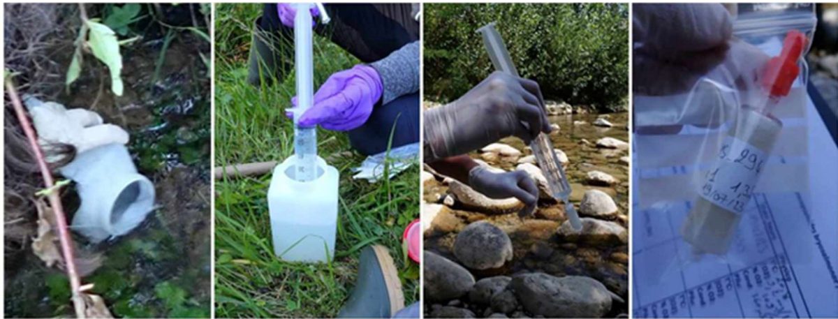
Figure 6. Illustration des étapes de prélèvement, de filtration et de préservation des échantillons d'eau filtrée (capsule Sterivex).
