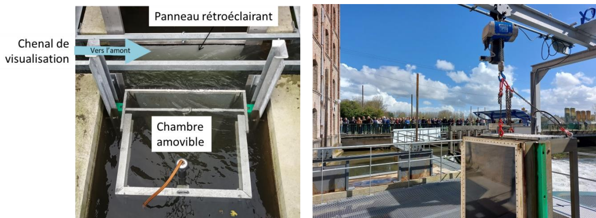
Figure 12 : Chambre amovible et panneau rétroéclairant de l'Ibaï Begi immergé dans le Bassin B0 (à gauche), et chambre amovible en levage le jour de l'inauguration (à droite)
